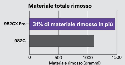
\*Risultati basati su un test automatizzato di 11 minuti su acciaio 1018 utilizzando i dischi fibrati 3M™ Cubitron™ II 982CX Pro da 7", grana 36+ e il platorello 3M™ 80514 su un servomotore.
